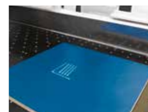
Les pièces signalées par ce symbole sont directement déposées par l'opérateur dans le dépôt manuel des chutes.
